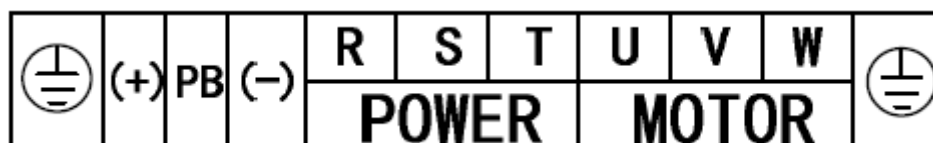
Рисунок 4.9. Клеммы силовой цепи (7,5 кВт)
