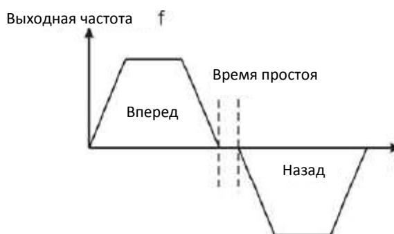
Рисунок 6.5. График задержки переключения вперед-назад (FWD/REV)
