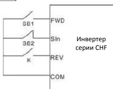
Рисунок 6.13. Трехпроводное управление режим 1.
