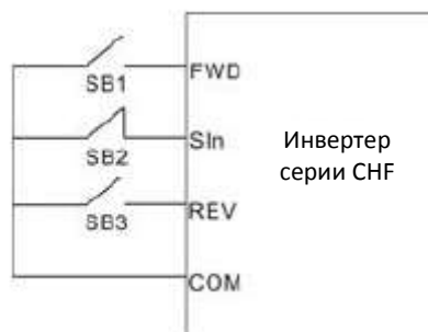
Рисунок 6.14. Трехпроводное управление режим 2.
