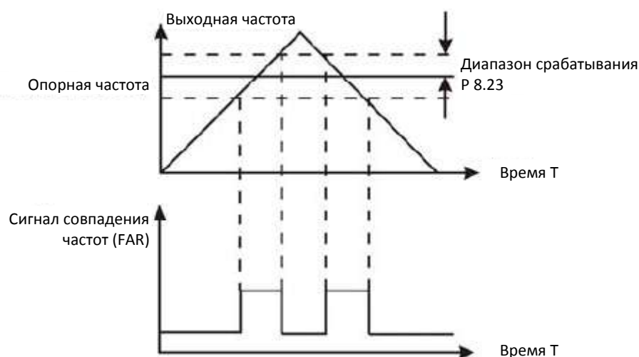
Рисунок 6.22. График сигнала совпадения частот (FAR).
