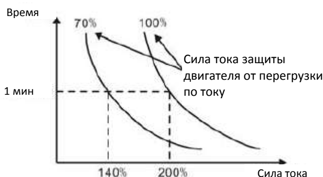
Рисунок 6.32. Кривые защиты двигателя от перегрузки по току.
