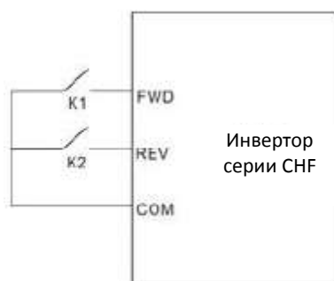
Рисунок 6.11. Двухпроводное управление режим 1.
