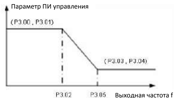
Рисунок 6.7. Диаграмма параметров ПИ управления
