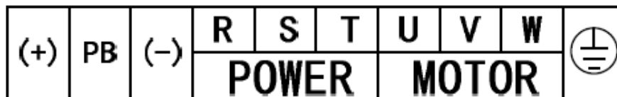
Рисунок 4.8. Клеммы силовой цепи (4–5,5 кВт)
