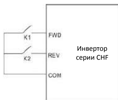
Рисунок 6.12. Двухпроводное управление режим 2.
